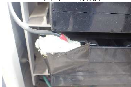
バッテリーボックスの腐食
