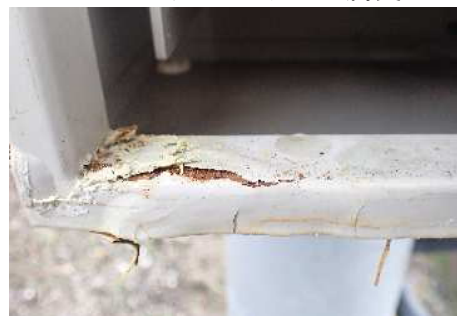
バッテリーボックスの腐食
