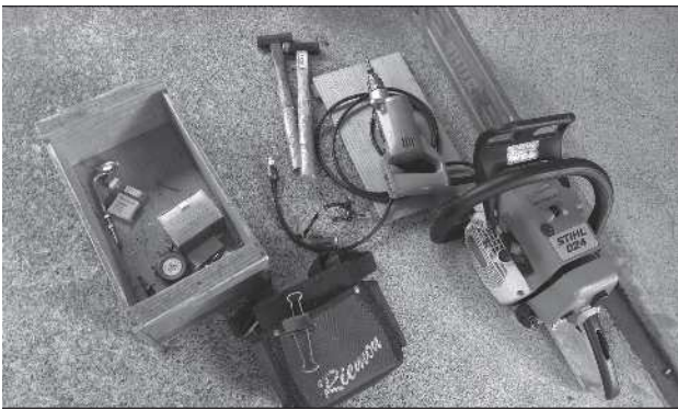
竹野さん愛用の仕事道具（左からメジャーなどの雑具、道具を入れる腰袋、種駒を打つトンカチ、種駒用の穴を開ける電動ドリル、伐採用のチェーンソー）
