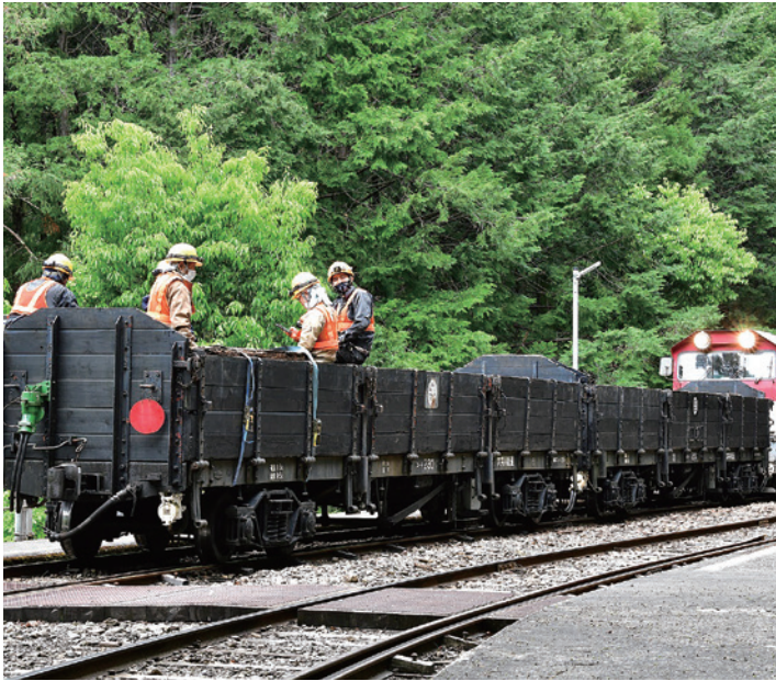
堆砂輸送用の候補「Cトキ200形井川線貨車」 全長11m、重量8.95t、荷重16t
