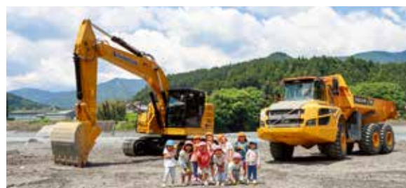
左がバックホウ、右がアーティキュレートダンプ
