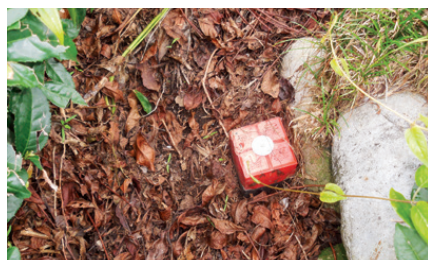
完了地域の地籍杭
