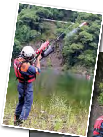
◀「救助索発射装置」を使用して要救助者へロープを届ける
